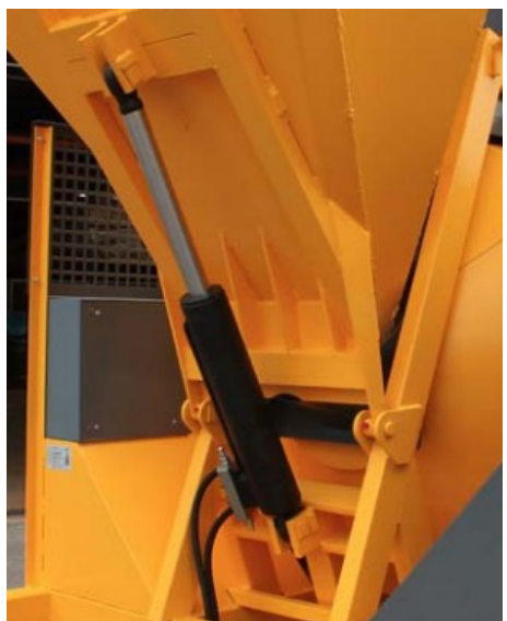
Sterke hydraulische lader, dubbel-werkende cilinder met veiligheidsventiel.
